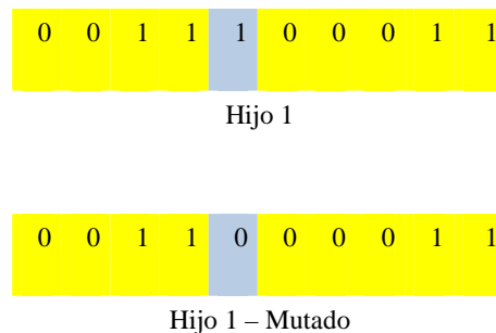
Figura 3.2. Operador de mutación
