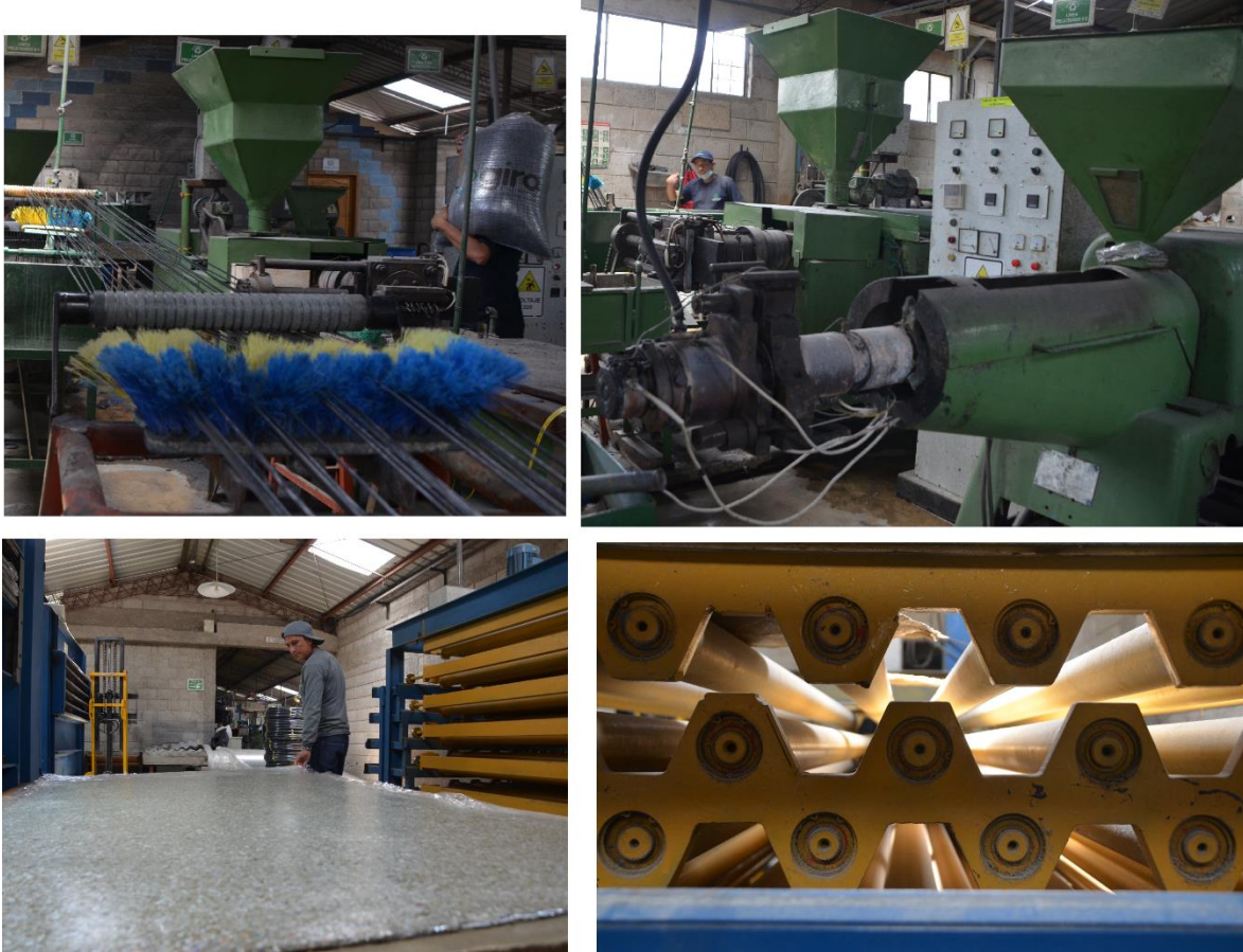
Foto 2.15 Peletizadora (izquierda superior), Extrusoras (derecha superior), Prensas de presión (izquierda inferior), Rodillos para prensar laminas (izquierda inferior) de la empresa ECUAPLASTIC
