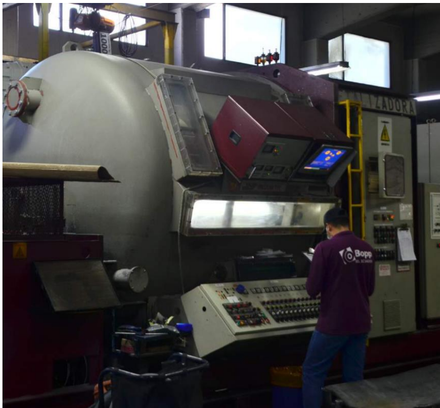
Foto 2.13 Metalizadora de alto vacío programada por operario
