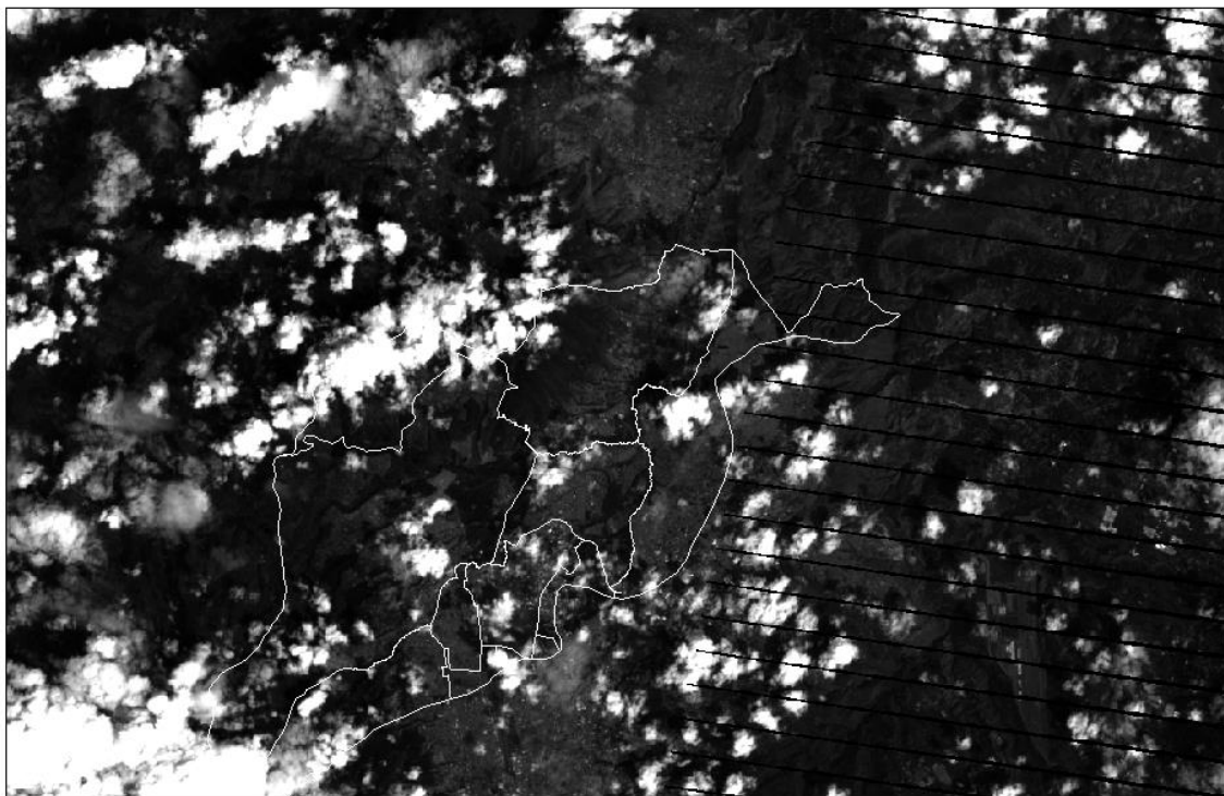
Figura 8. Error de bandeo en la imagen satelital del año 2011
