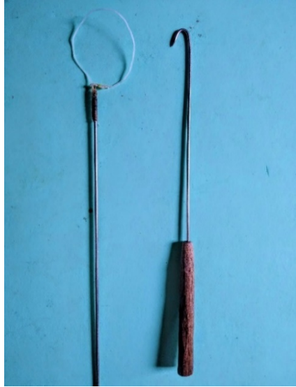
Figura 2.11 Implementos para la extracción de crustáceos: lazo y gancho. Fuente: Trabajo de campo
