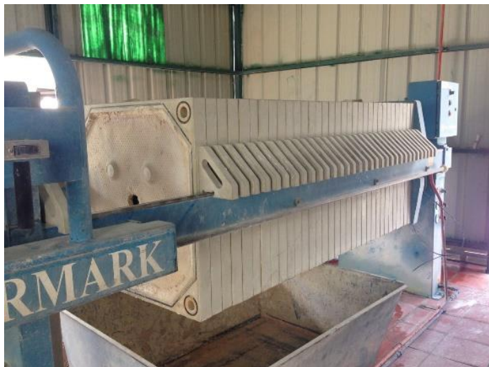
Fotografía 11. Filtro prensa en proceso de prensado de lodos. Fuente: Fotografía tomada del trabajo de campo 2017
