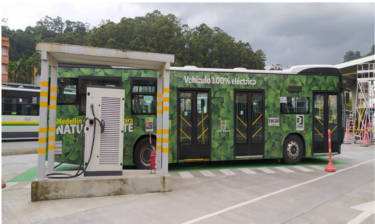
Fotografía 2. 2. Estación de recarga de las baterías. Estación Universidad de Medellín. Fuente: Trabajo de campo
