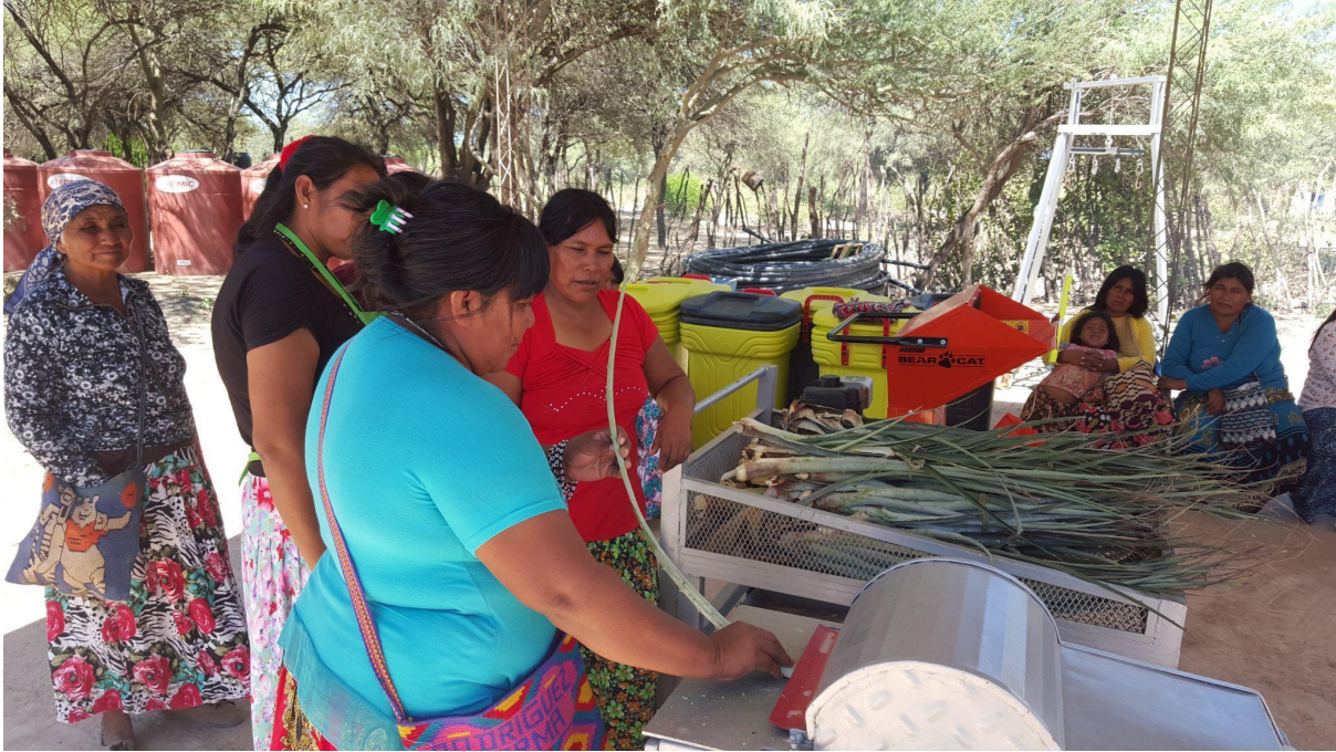
Imagen 19: Desfibradora de chaguar diseñada por el INTI en la As. Hinaj. Foto de Nicolas Heredia, 2019.
