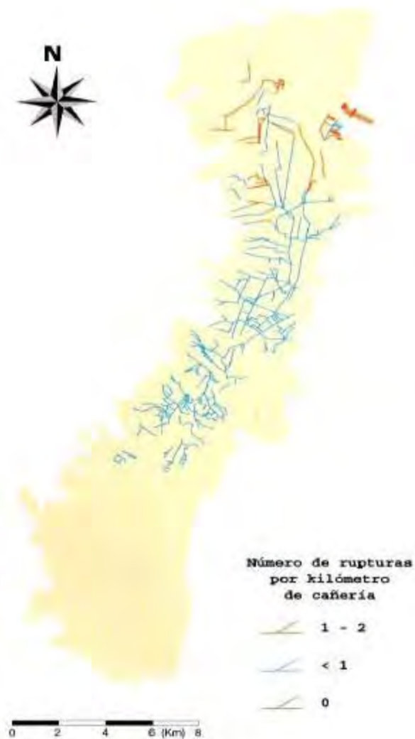
FIGURA 13. ESTIMACIÓN DE DAÑOS EN LA RED PRINCIPAL DE ALCANTARILLADO, PROVOCADOS POR EL SISMO LOCAL (SL)
