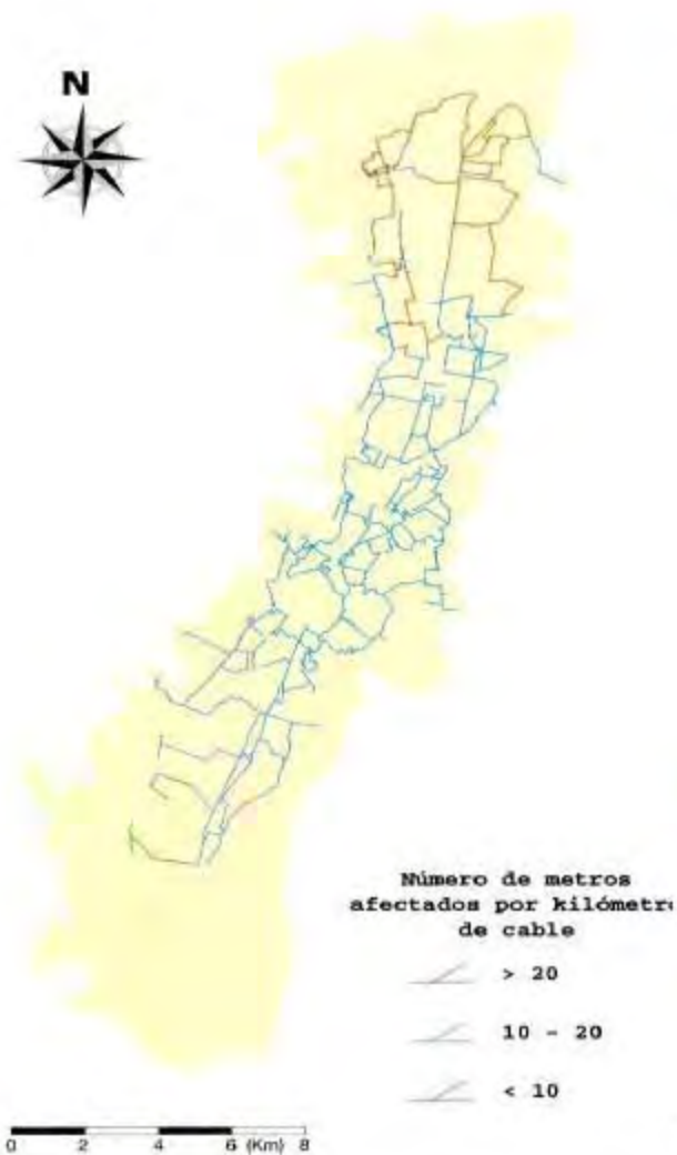
FIGURA 12. ESTIMACIÓN DE DAÑOS EN LA RED PRINCIPAL DE DISTRIBUCIÓN DE ENERGÍA ELÉCTRICA, PROVOCADOS POR EL SISMO LOCAL (SL)
