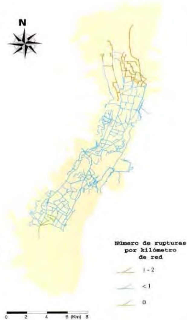
FIGURA 11. ESTIMACIÓN DE DAÑOS EN EL SISTEMA DE AGUA POTABLE PROVOCADOS POR EL SISMO LOCAL (SL)
