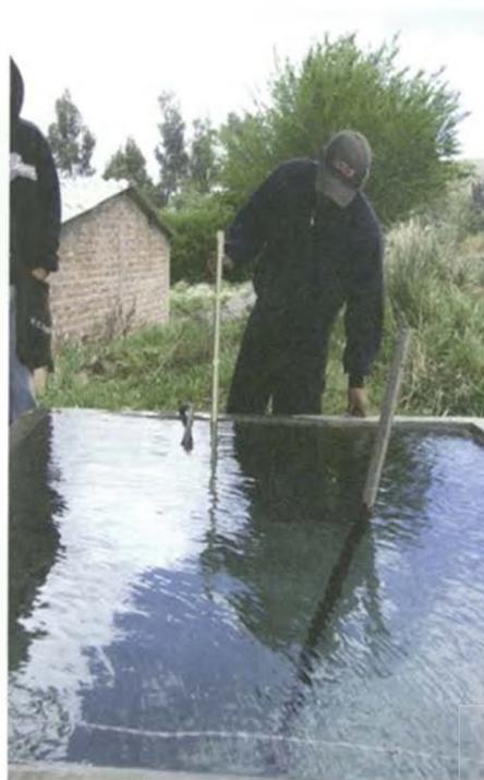
Foto 24. Medición del caudal de agua que se utilizó para el análisis del sistema de riego
