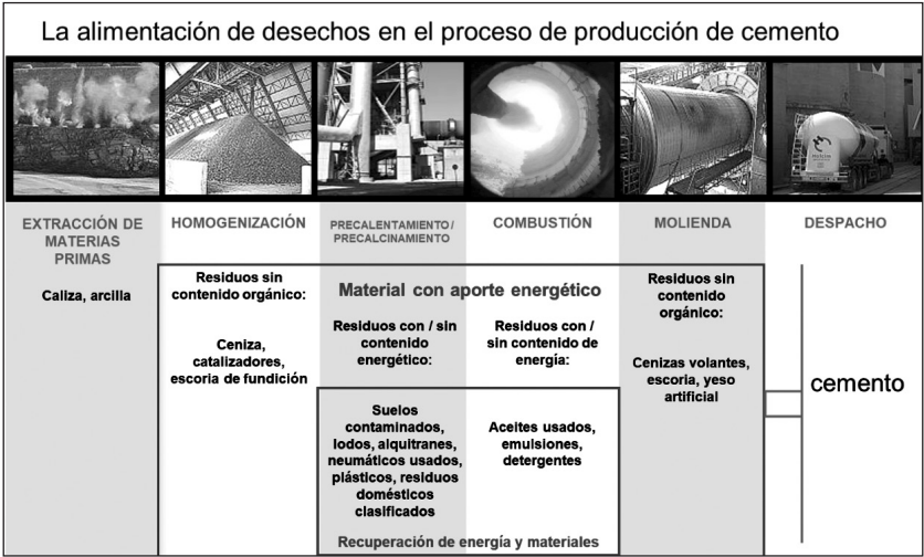
Figura 4: Coprocesamiento en la industria del cemento.
