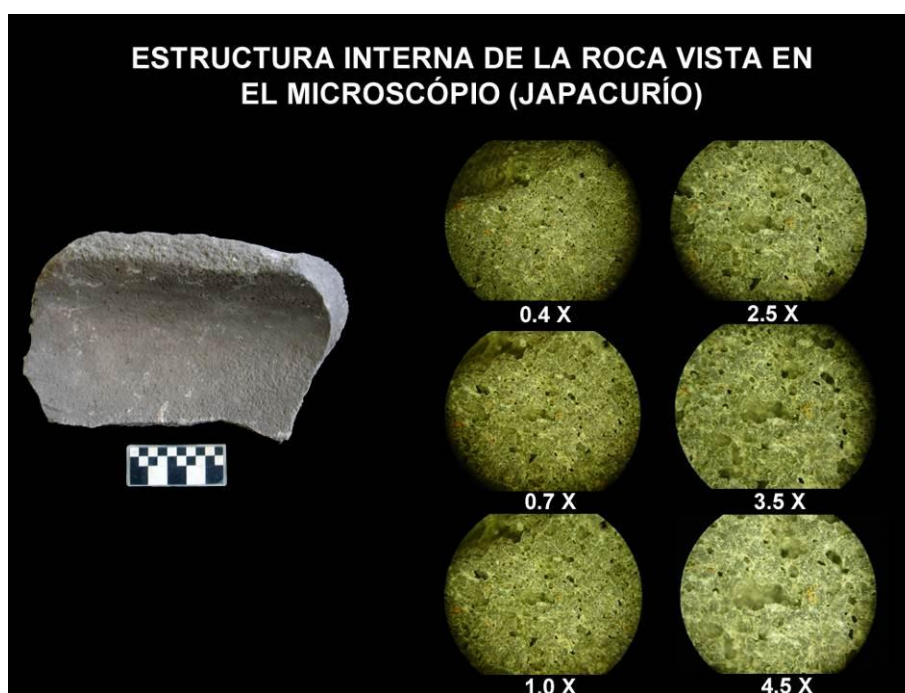
Fotografía 29 Vista al microscopio de la muestra de Zaragoza.
