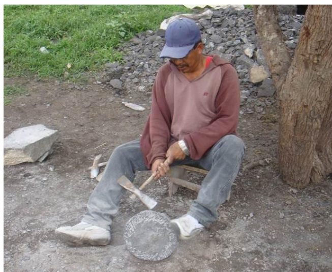
Fotografía 20 Artesano iniciando sus actividades de trabajo, una preforma ya con forma de cono truncado.
