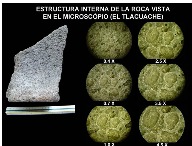
Fotografía 28 Estructura interna de muestra de El Tlacuache.
