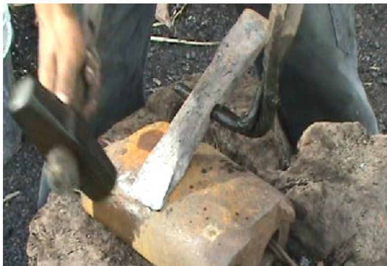
Fotografía 24 Afilado de herramientas en la localidad de El Tlacuache.
