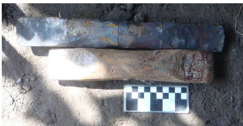
Fotografía 22 Pedazos de metas de los ejes de vehículos para la fabricación de herramientas.
