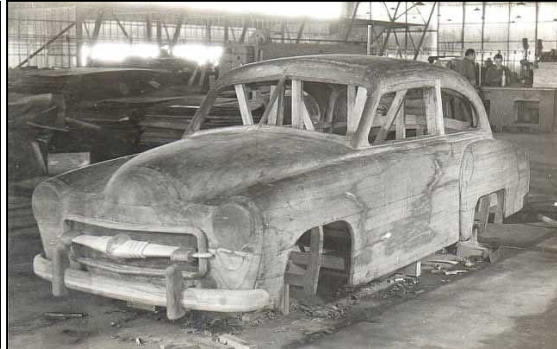
Foto N° 4 (secuencia) – Proceso de diseño del primer automóvil de producción estatal: Sedan Institec /Justicialista
