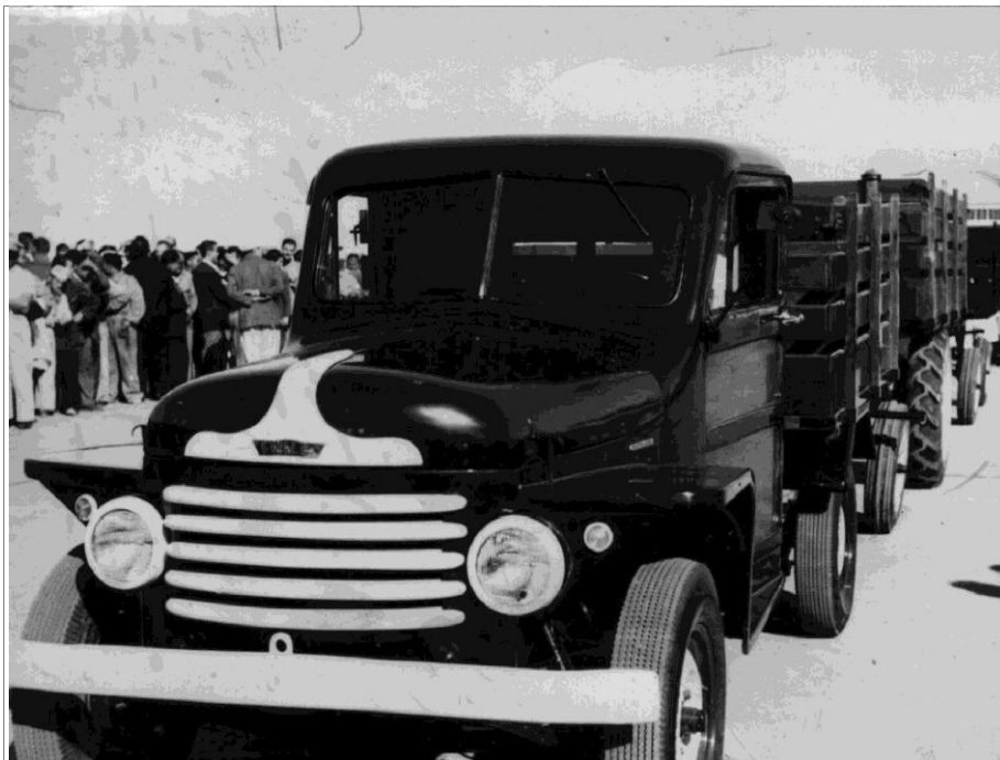
El artefacto fue fabricado a partir de las piezas no utilizadas del tractor Empire. La foto permite observar las ruedas de diferentes dimensiones. Fuente: Archivo Fotográfico del Museo de la Industria
