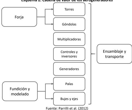
Esquema 2. Cadena de valor de los aerogeneradores
