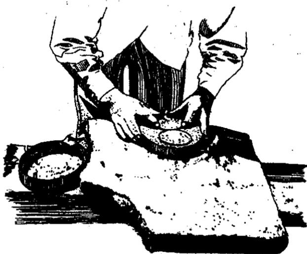
Se coloca la segunda parte de la caja, tapa macho, concertándola con el machihembrado, y se la llena de tierra húmeda, cubriendo totalmente el molde que queda en el centro del interior.
