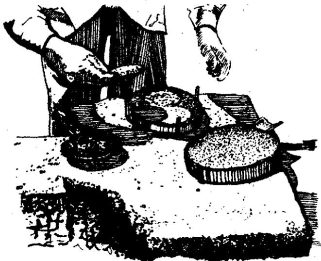
Si han quedado pegados trozos de tierra al molde considerables, hay que volver a amoldar por segunda ocasión. Si las fallas son menores se reparan con habilidad de modeladores, comparando visualmente el molde y el amoldado, utilizando para éste trabajo el barrero y el cargador con barro más diluido.
