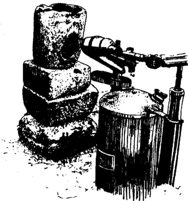
Un crisol de "plombagina" ha sido transformado en horno de fundir, principalmente oro, dadas las reducidas dimensiones del "horno" para realizar el fundido se coloca un "crisol" pequeño conteniendo el metal, dentro del horno, a este se lo sienta sobre unos cuantos ladrillos y se lo tapa con un pedazo de teja, que tiene la función de mantener y elevar la temperatura.
