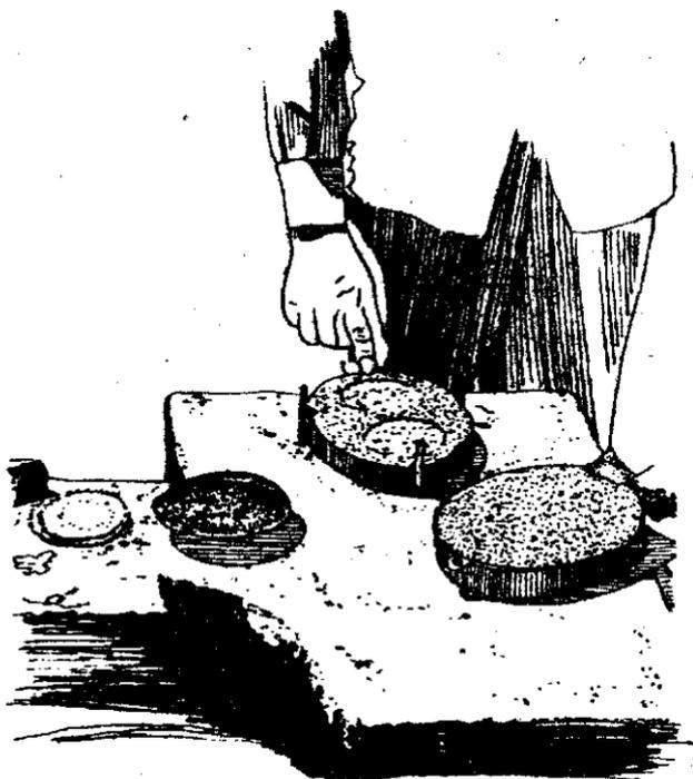
Con la punta del cargador se realizan pequeñísimas hendiduras o canales que van desde la parte inferior del amoldado hasta la parte superior de la caja y por donde escaparán los gases calientes producidos durante el vaciado y el aire del amoldado, sin dejar regar la plata, oro u otros metales fundidos.
