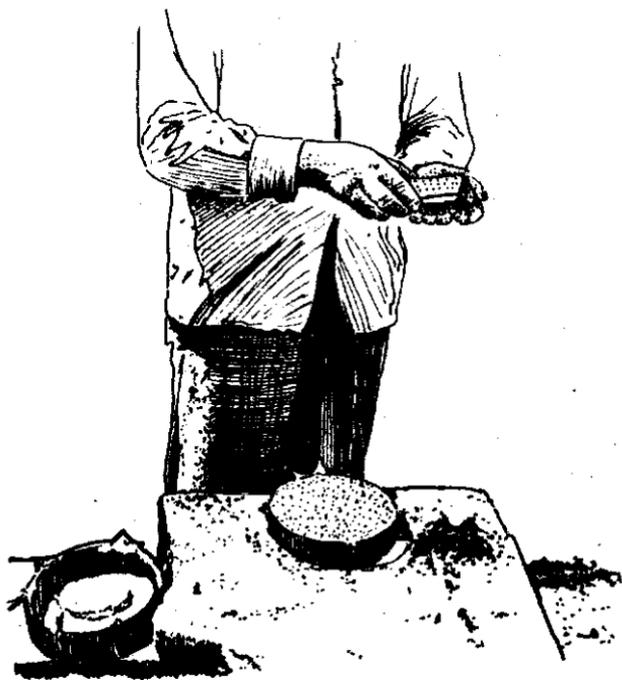
En la superficie doblemente pulida, se colocan los moldes con la cara hacia arriba y se le da imprimación con ayuda del palo desde los cuatro costados por igual.
