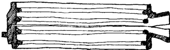
En la superficie interna de la caja se necesita de una muesca canal a varilla para la contención de la tierra. Sección de cajas de dibujos página 24.
