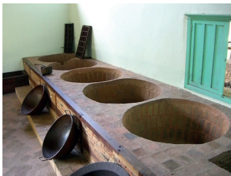
Figura 2. Tren de pailas y moldes para la panela. Trapiche Los Clavo. Boconó, estado Trujillo Foto: L. Molina.
