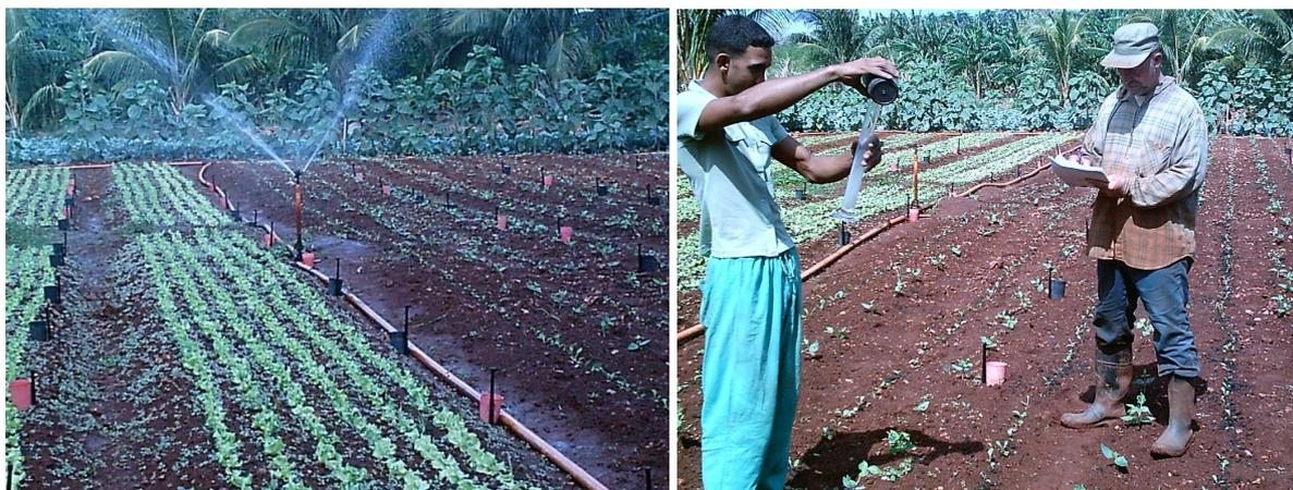
**Figura 6. Evaluación de campo de la pluviometría de un aspersor en el área seleccionada para el estudio**
