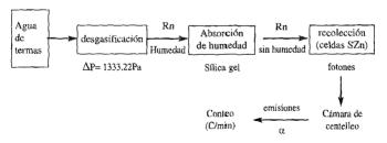
Fig. 2. Esquema del Equipo (Pylon modelo RM-1003).
