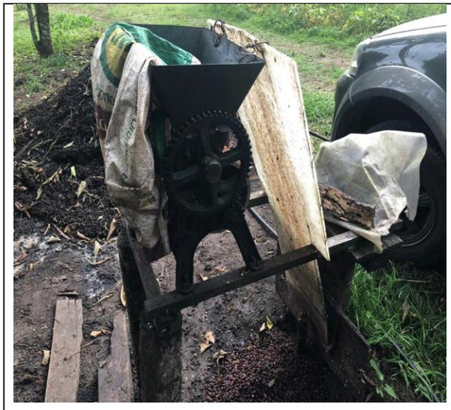
Foto 12. Maquina despulpadora de café
