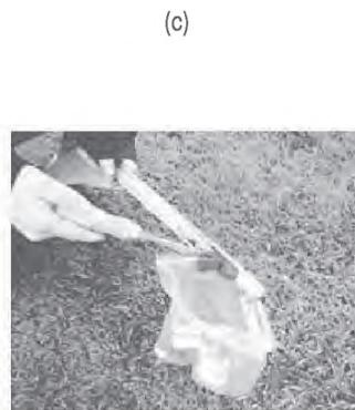
**Figura 16.** (a) extracción de muestra de suelo con el barreno, (b) retiro de la muestra de suelo con la ayuda de cuchillo y (c) depósito de la muestra en funda plástica.
