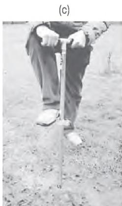
**Figura 15.** (a) marcación de las profundidades de muestreo, (b) penetración del cilindro de manera perpendicular al perfil del suelo para extraer la submuestra de suelo y (c) muestra de moldura de golpe y cilindro.
