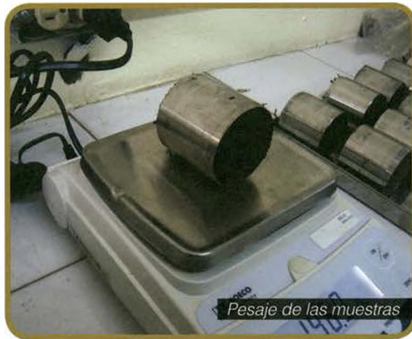
4. Secar la muestra en el horno a 105°C por aproximadamente 24h. Una vez que la muestra esté seca, pesarla junto con el cilindro y anotar este resultado.
