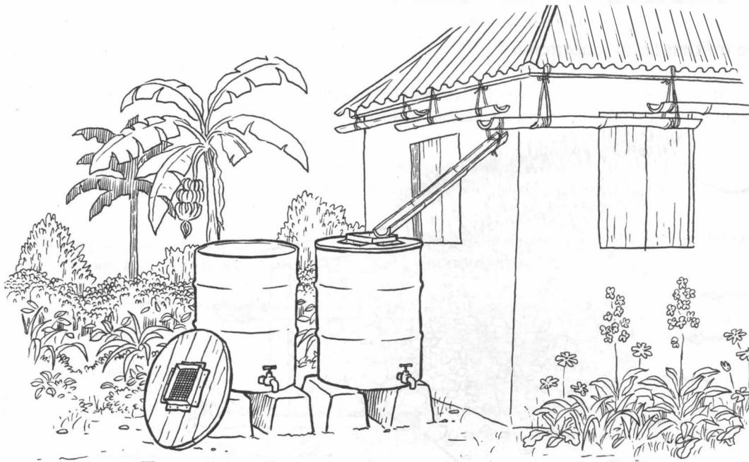
Uso de un techo de lámina de estaño para captar agua de lluvia.
