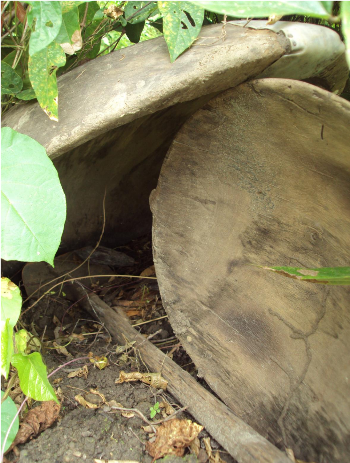
Fotografía 3: Instrumentos para la playada: pala y al menos una batea para lavar la tierra extraída del hueco.
