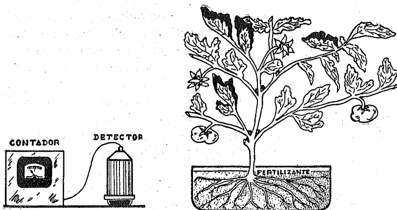
Figura 3.—Planta con fertilizante fosfatado y detector Geiger
