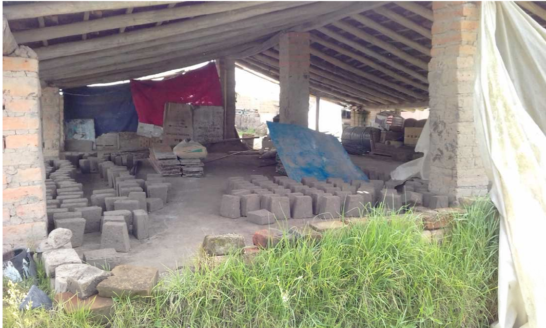
Autora. 2017. Proceso de secado de tejas y ladrillos. Santa Rosa del Tejar-Imbabura.
