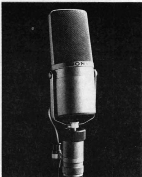
*Este micrófono bidireccional permite emitir el sonido por la cara anterior y la posterior*
